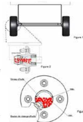
Effectuer un contrôle de l'état et du niveau d'huile au minimum une fois/an. L'huile recommandée par LIDER est l'huile hydraulique type H46. Respecter le niveau indiqué sur le réservoir ou le remplir complètement s'il n'y a pas de marquage. Pour les pompes manuelles, il est recommandé de remplir à 90% du volume maximum, ceci afin d'éviter tout reflux lors de la descente du vérin
