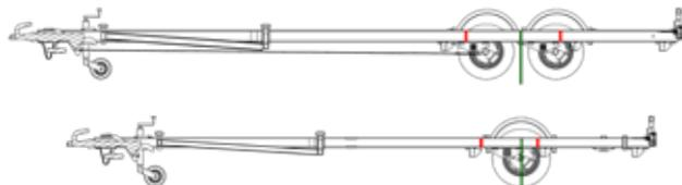
La tringlerie de freinage doit être soutenue en un point minimum sur sa longueur en raison de son poids (support d'étrave, guide...)
