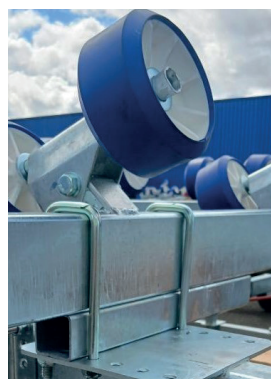
Réhausse chemin de roulement
